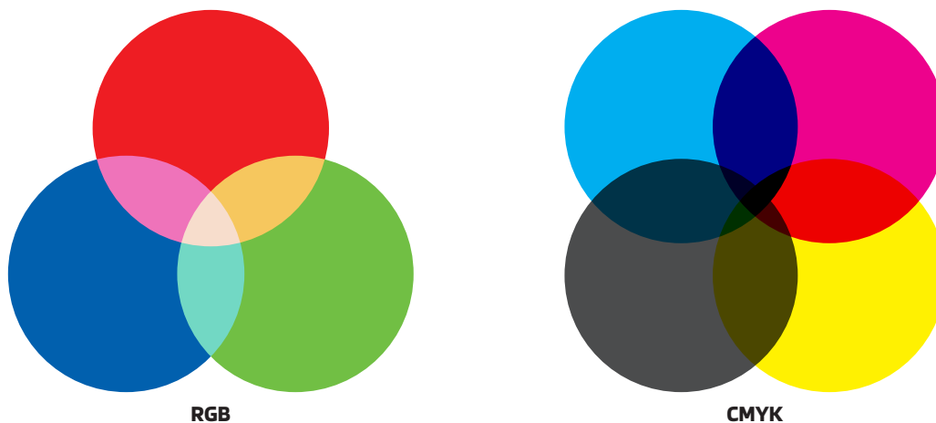
Abb. 2: Farbmanagement bleibt eines der wichtigsten Themen auf dem Weg zum gewünschten Ergebnis. Während das ICC-basierte Farbmanagement sehr gut für Bildmaterial funktioniert, liefert die Konvertierung von RGB zu CMYK für Vektordaten und Texte „unerwartete“ Ergebnisse.
